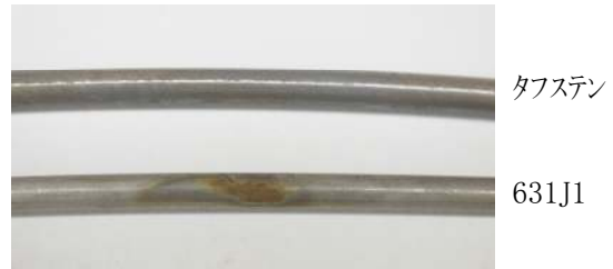
写真1 塩水噴霧試験結果(96h)
